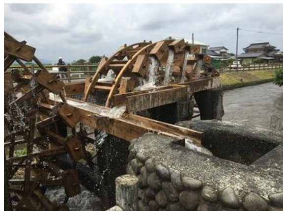
水車に取り付けられた柄杓 ひしゃく で 水が汲み揚げられます
