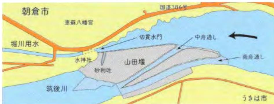
南舟通し、中舟通し、砂利吐きの3つの部分に区分されており、取水量を増やし、激流と水圧に耐
