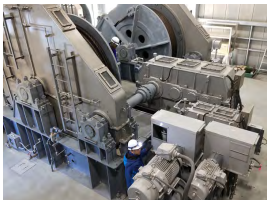
選択取水設備を上下させる装置
