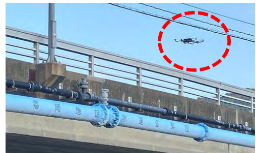
水管橋の劣化状況をドローンで撮影 (水色の管が当企業団の水道管)
