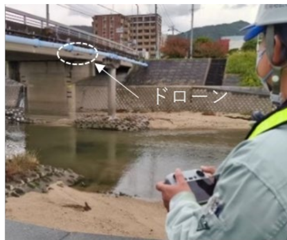
ドローンでの点検
